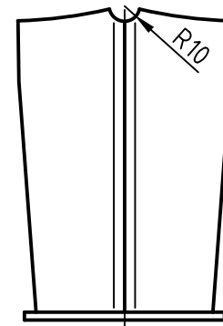
Muffeneinschweißung Entlüftungs- u. Abblaufmuffe innen bündig
